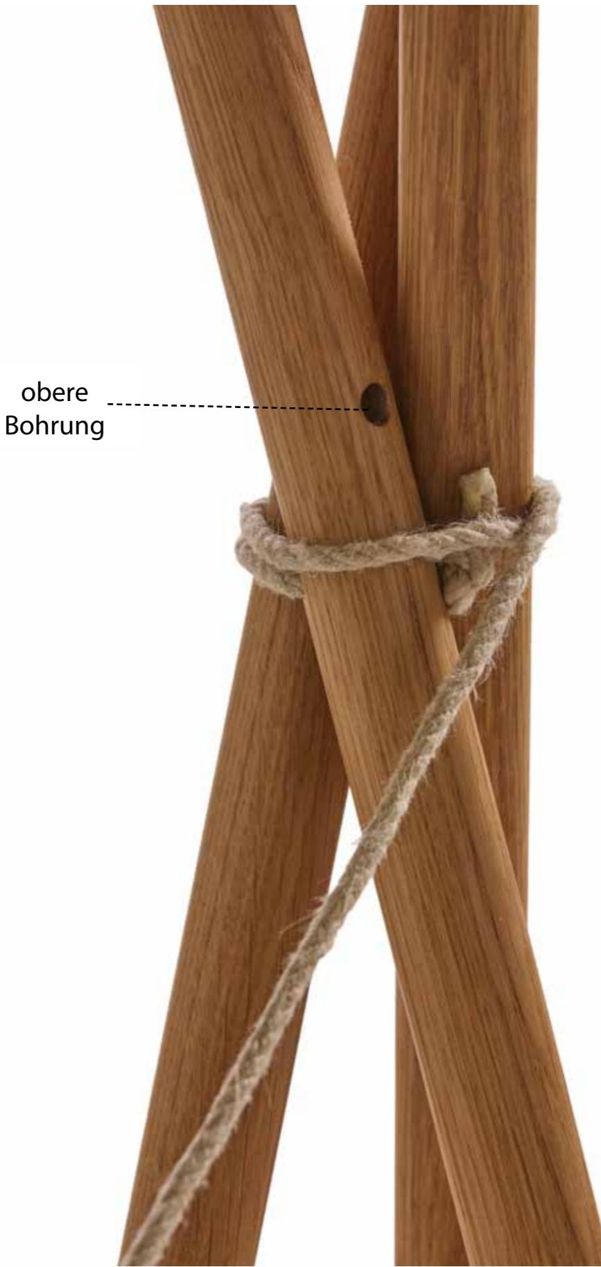
**7.** Das Seilende in Wickelrichtung durch die obere Bohrung im Holm führen.
