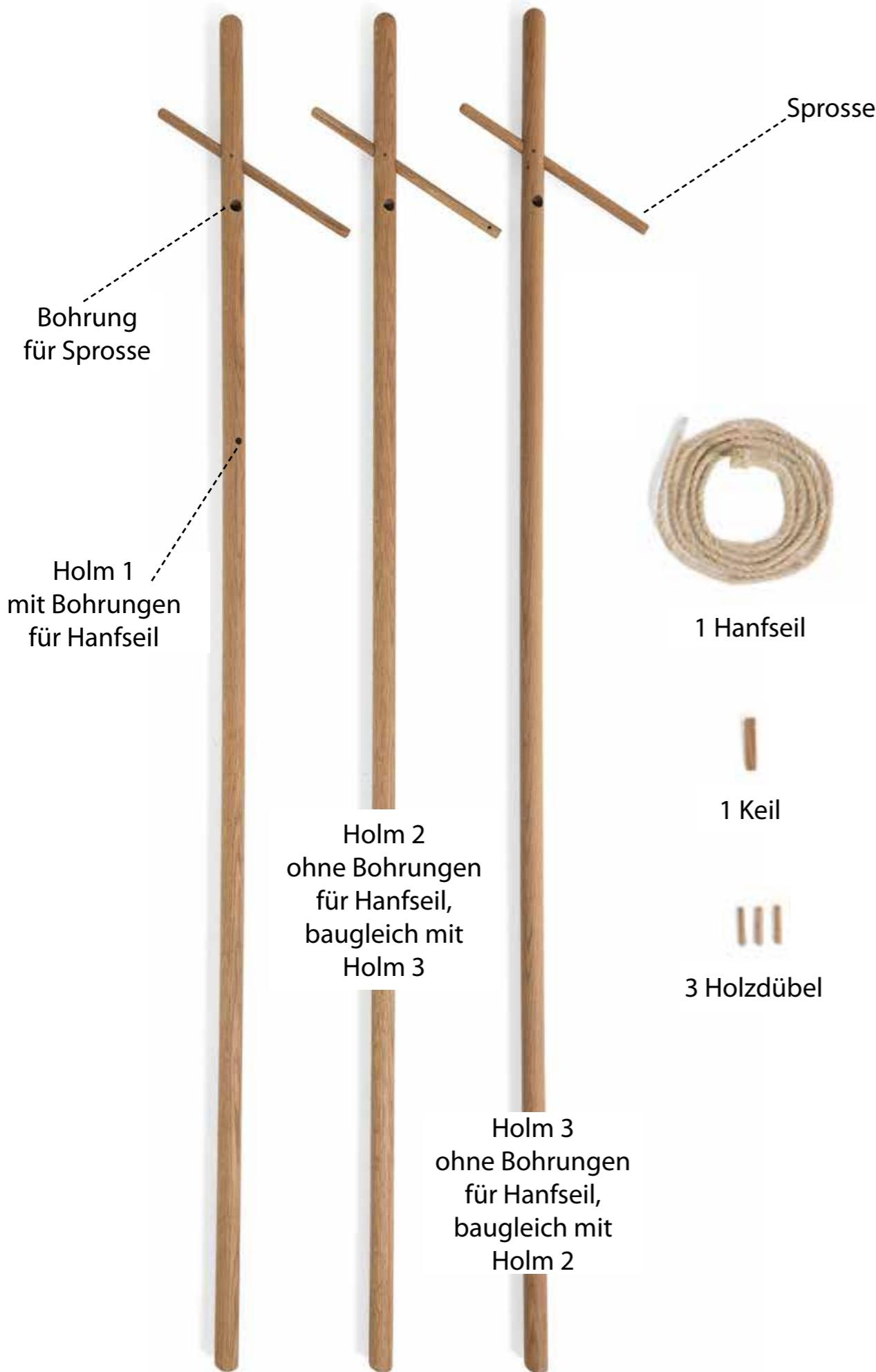
1. Holm 1 und 2 überkreuzen wie dargestellt. Dann die Sprosse von Holm 2 bis zum Anschlag in die Bohrung von Holm 1 stecken.
