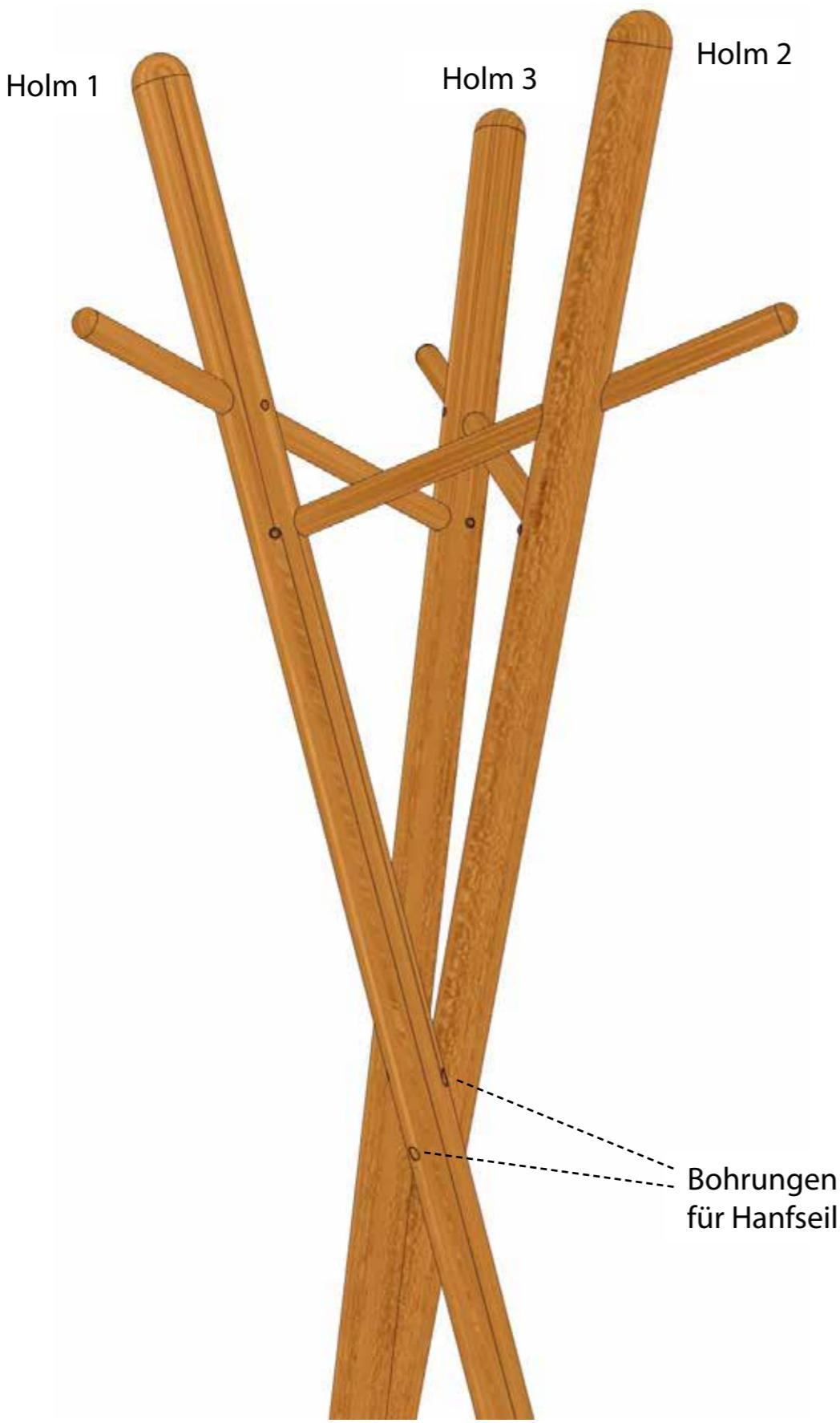
**5.** Hanfseil wie dargestellt durch die **untere** Bohrung in Holm1 fädeln und bis zum Anschlag des Knotens straffziehen.
