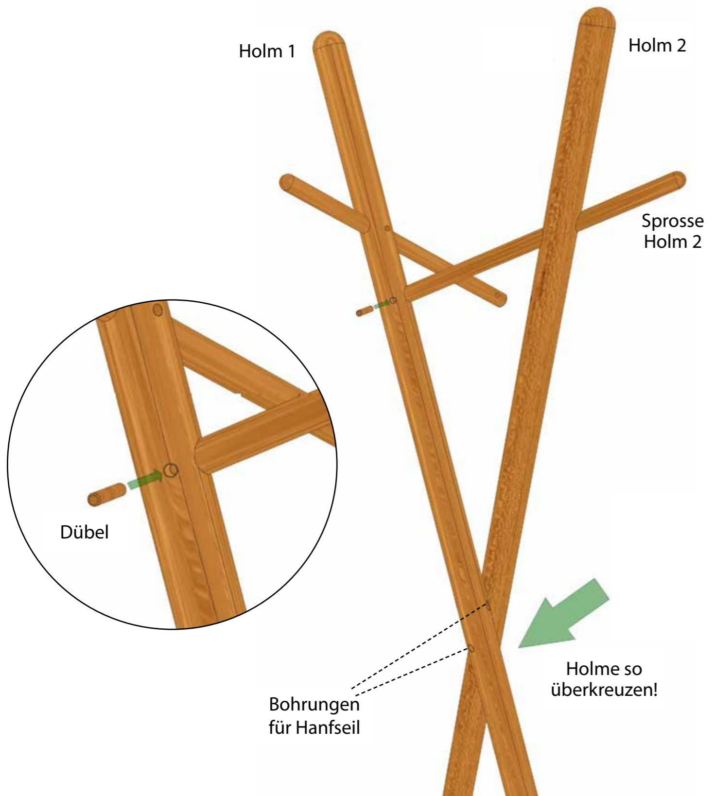
**3.** Holm 3 wie dargestellt zu den Holmen 1 und 2 positionieren. Dann Holm 1 etwas anheben und dessen Sprosse in die Bohrung von Holm 3 stecken. Gleichzeitig die Sprosse von Holm 3 in die Bohrung von Holm 2 stecken. Falls notwendig: die Sprossen mit einem Gummihammer vorsichtig anklopfen.
