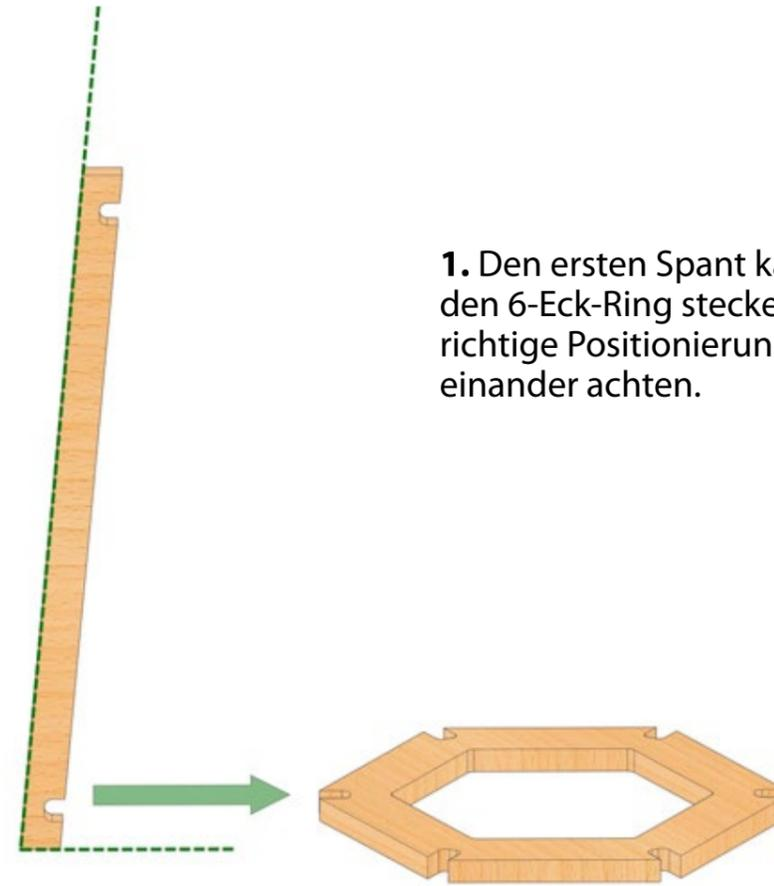
**1.** Den ersten Spant kantenbündig auf den 6-Eck-Ring stecken. Dabei auf die richtige Positionierung der Bauteile zueinander achten.
