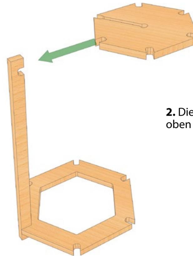
**2.** Die 6-Eck-Platte kantenbündig oben auf den Spant stecken.
